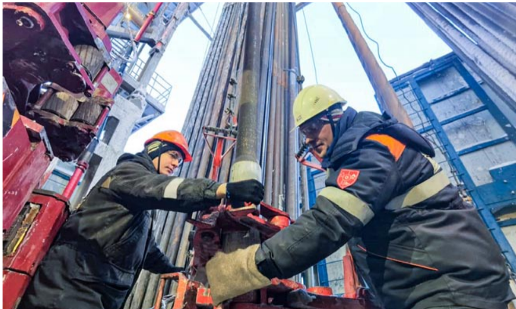
Выполнение операции по подъему бурильной колонны
